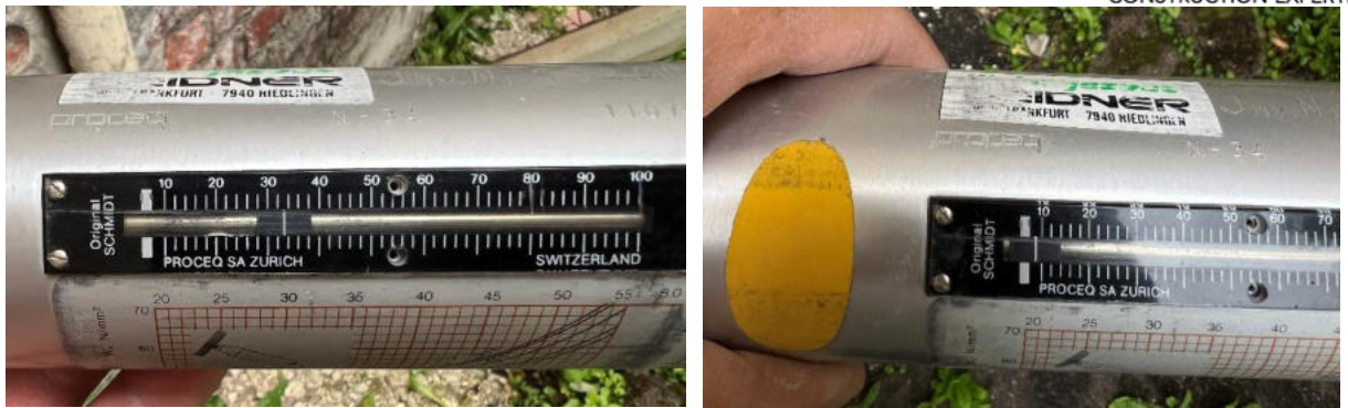
49-50 pav. Nustatyti mūro bei jo siūlių skiedinio stipriai
