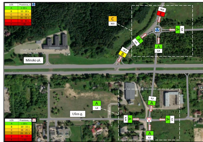
2.30 pav. „II alternatyva + 20 m.“ Eismo kokybės lygis ir prastovos laikas rytinio piko metu.
