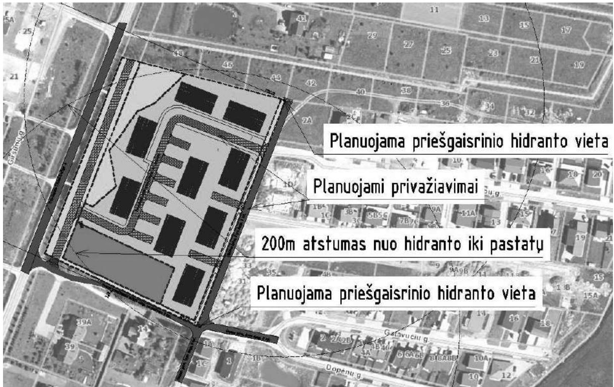
Planuojamų priešgaisrinių hidrantų išdėstymo schema
