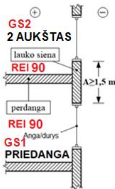
Pav. 1. Vertikalaus ugnies plitimo ribojimo reikalavimai (statinio pjūvis). A- lauko sienos, atitinkančios REI 90 atsparumo ugniai, matmenys.
