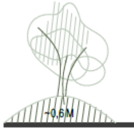
Kalvelių schema krūmų sodinimui ant perdangos
