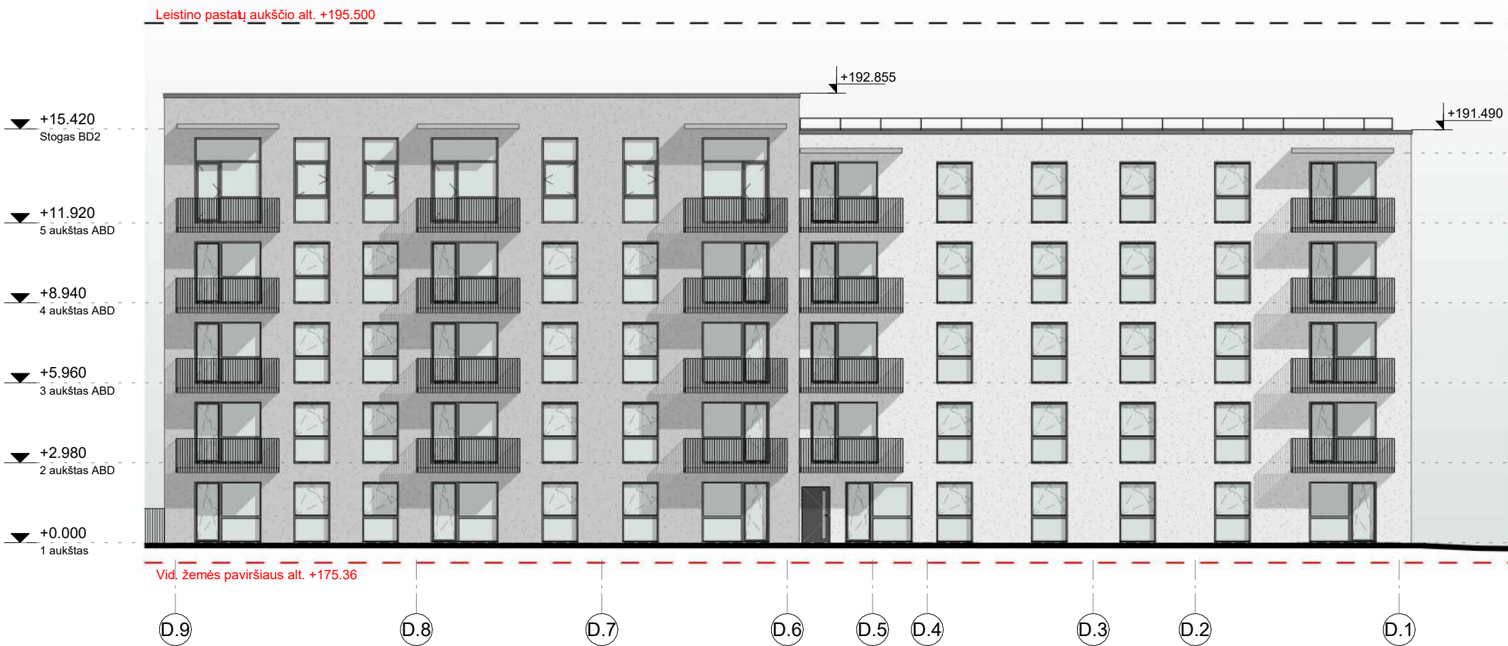
7. FASADAS TARP AŠIŲ D.9 - D.1 (Kiemo fasadas) 1 : 200
