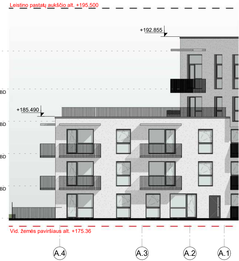
8. FASADAS TARP AŠIŲ A.4 - A.1 (Kiemo fasadas) 1 : 200
