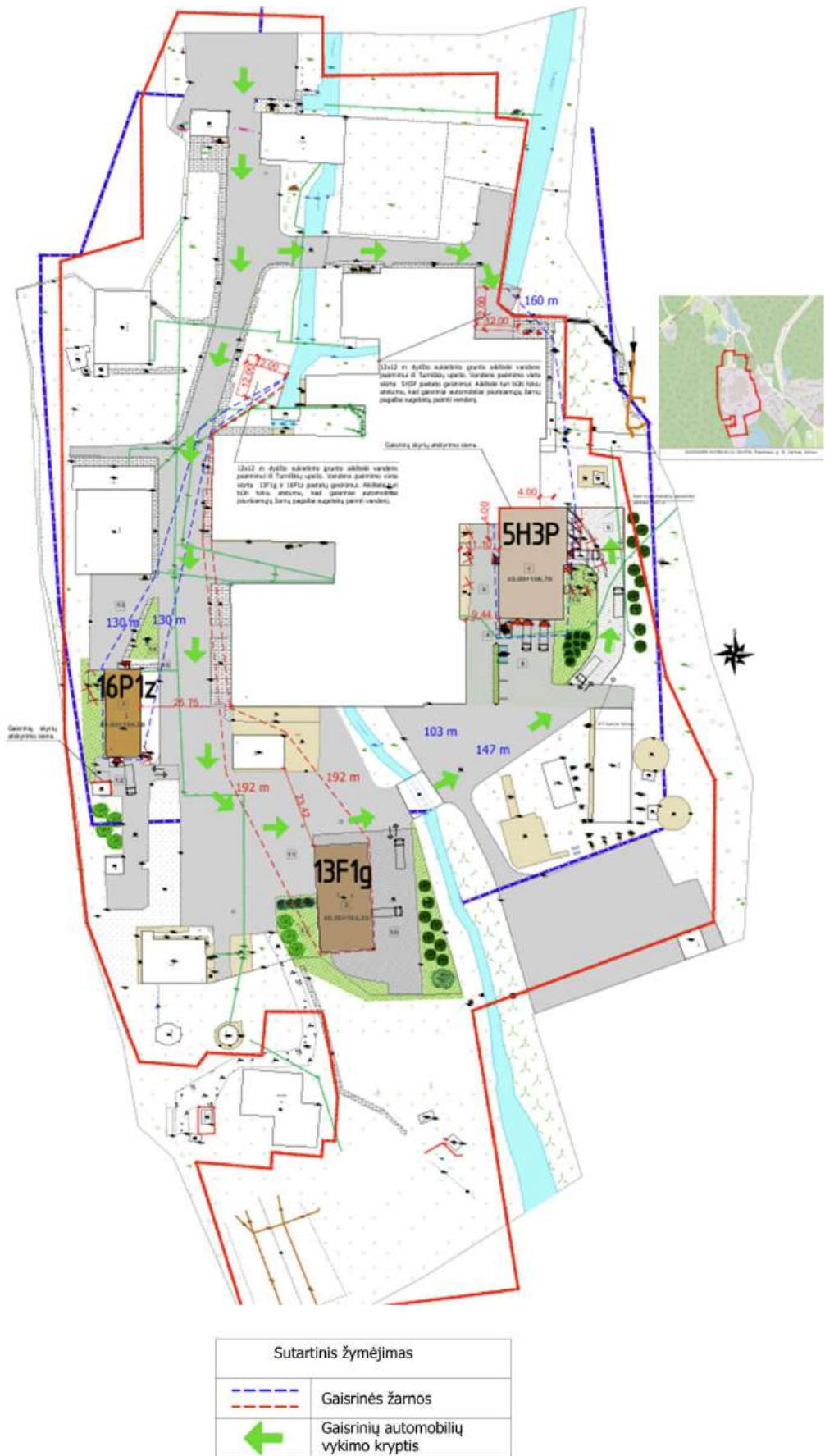
14. pav. Gaisrų gesinimo ir gelbėjimo automobilių įvažiavimo į sklypą, privažiavimo prie statinių ir apsisukimo (jei reikia) aikštelės
