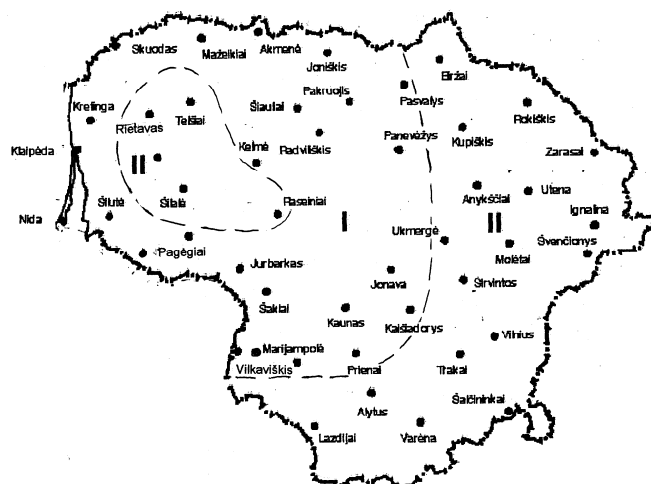
Pav. 2. Lietuvos sniego apkrovos rajonai I - s_k = 1,2 \text{ kN/m}^2 , II - s_k = 1,6 \text{ kN/m}^2 .
