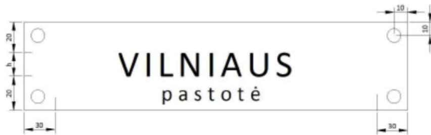
1 pav. 110-330 kV transformatorių pastočių pavadinimo lentelė
